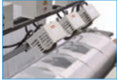
Sıcak Dilimleme Ünitesi
